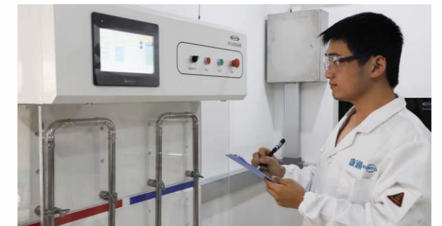
水压冲击试验 Water pressure shock test
